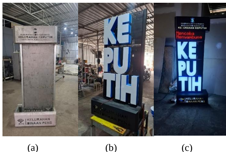
Gambar 5. Proses produksi totem: (a) pembuatan rangka besi utama; (b) pembuatan letter signage akrilik "KEPUTIH" dengan LED; (c) pengujian pencahayaan dan fungsi komponen di dalam ruangan.
