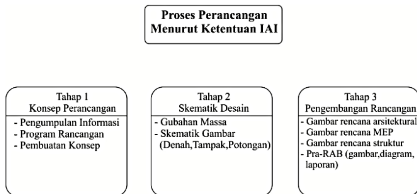
Gambar 1. Proses Perancangan Bangunan Gedung Menurut IAI.
