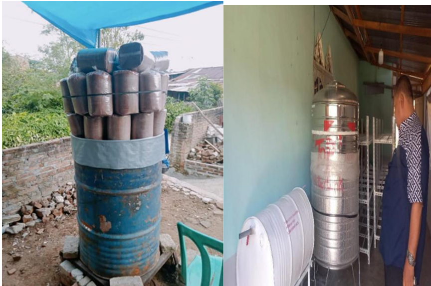
Gambar 1. Alat kukus milik mitra sebelum intervensi (kiri) kapasitas kukus 70 baglog perbatch dan mesin steamer hasil karya TimPKM yang diserahkan kepada mitra kapasitas kukus 350 baglog perbatch.
