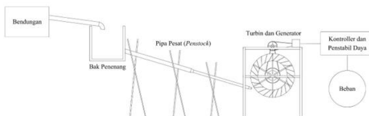
Gambar 6. Skema Teknis Instalasi PLTMH.
