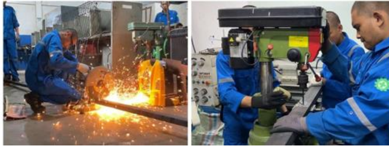
Gambar 11. Proses Manufaktur Rangka PLTMH.
