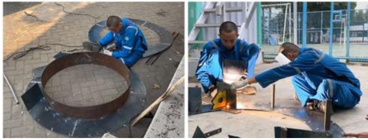
Gambar 9. Proses Manufaktur Turbin PLTMH.
