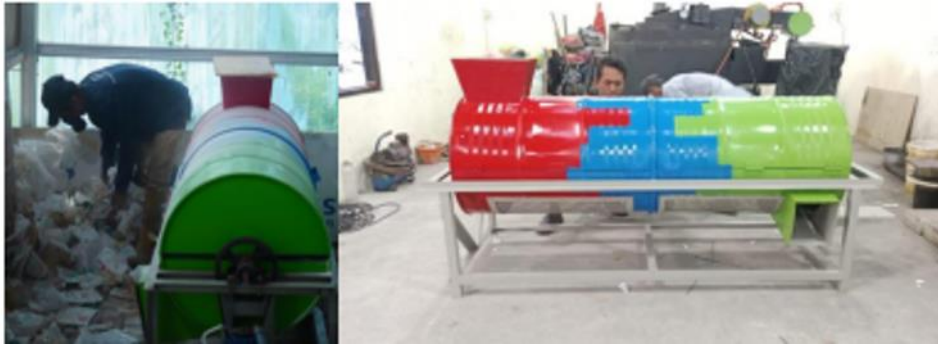
Gambar 2. Mesin Pengering sampah plastik POJA-PETA.
