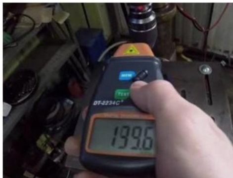
Gambar 5. Pengukuran kecepatan motor dengan tachometer.
