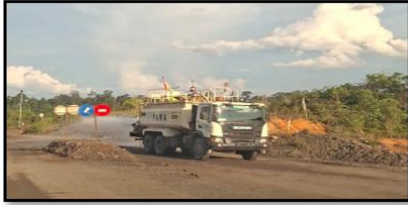
Gambar 14. Penyiraman Jalan Angkut menggunakan Water Truck .
