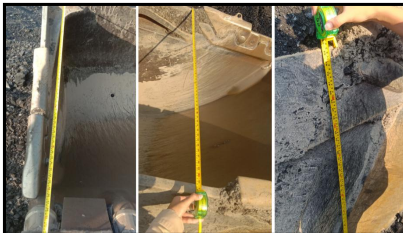
Gambar 2. Pengukuran Dimensi Bucket PC 300.
