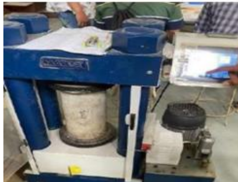
Gambar 4. Pengujian Kuat Tekan Beton.
