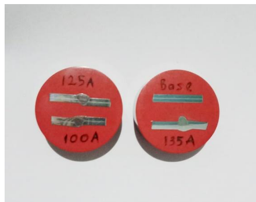
Gambar 4. Spesimen untuk Pengamatan Struktur Mikro.
