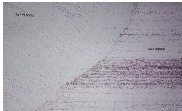
Gambar 9. Struktur Mikro pada Hasil Las 125 A.
