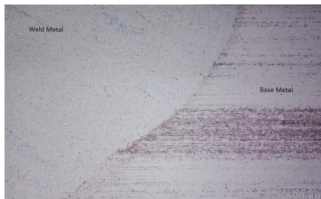
Gambar 8. Struktur Mikro pada Hasil Las 100 A.
