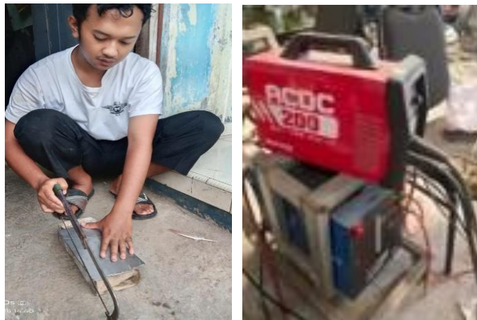
Gambar 2. Proses pemotongan dan pengelasan variasi 100 A,125A,135 A.
