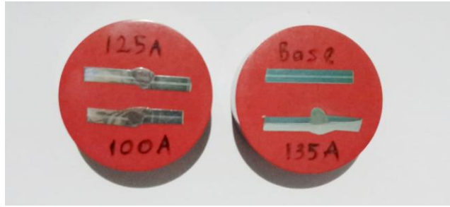
Gambar 6. Sampel Spesimen Uji Analisa Struktur Mikro.
