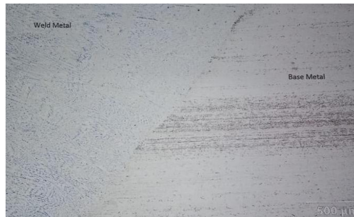
Gambar 10. Struktur Mikro pada Hasil Las 135 A.
