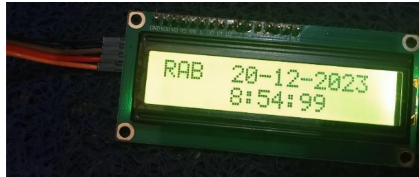
Gambar 9. Pemasangan pada LCD I2C
