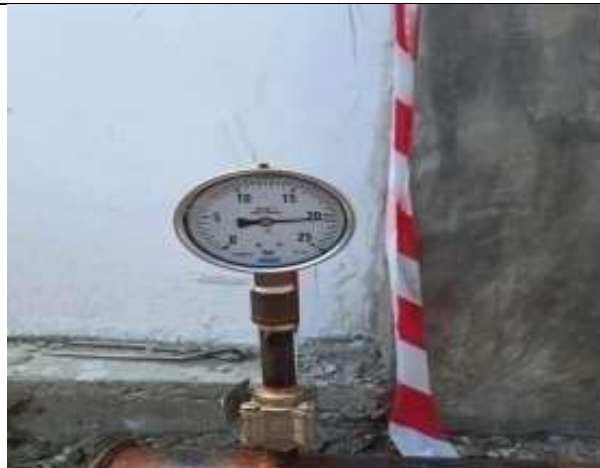
Gambar 3. Tidak terdapat penurunan tekanan Tahap release (pelepasan tekanan).
