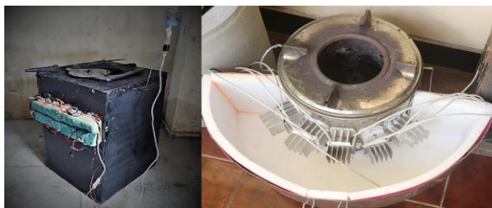
Gambar 11. Perbandingan sistem pendingin generator termoelektrik.
