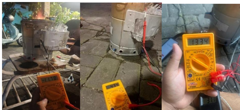
Gambar 7. Hasil pengujian termoelektrik terhadap kompor biomassa.
