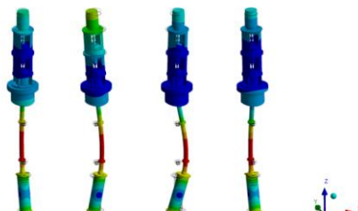
Gambar 9. Modus Getar ke 5 (23 Hz), 6 (23 Hz), 7 (26 Hz) dan 8 (26 Hz)
