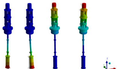
Gambar 8. Modus Getar ke 1 (2 Hz), 2 (2 Hz), 3 (12 Hz) dan 4 (17 Hz)
