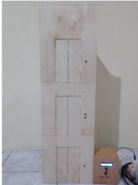
Gambar 7. Hasil Desain Prototype Lift 3 Lantai dengan Proteksi Sling Putus.
