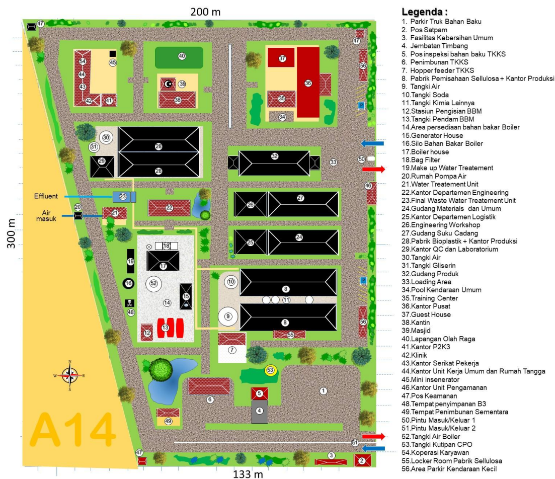
Gambar 5. Rancangan tata letak industri terpadu bioplastik starch cellulose blend berbahan baku TKKS dalam suatu kawasan komersial
