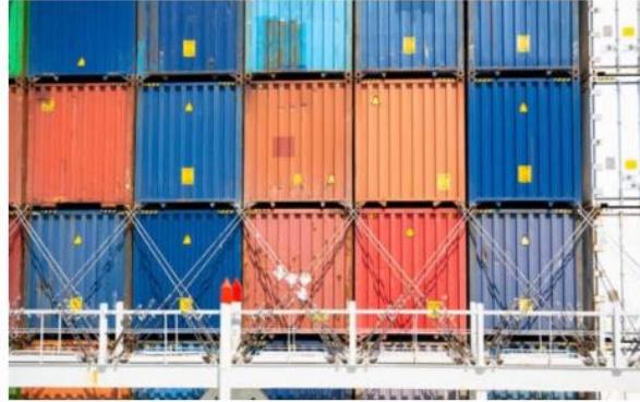
Gambar 3. Pengikatan/lashing double lashing pada peti kemas
