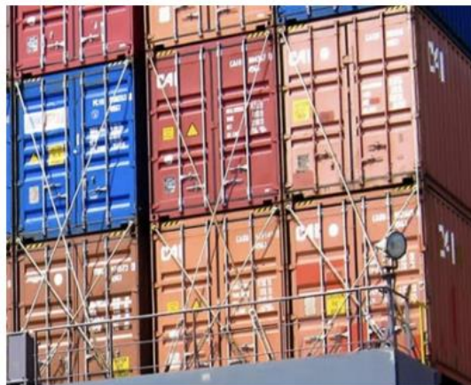
Gambar 4. Pengikatan/lashing crossing lashing pada peti kemas.
