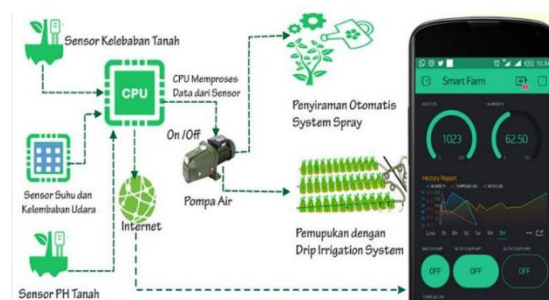
Gambar 1. Skema Proses Penyiraman Pada Lahan Petani Sumber
