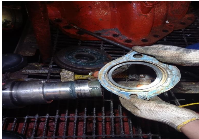
Gambar 6. kondisi seal face dan ball bearing .Sumber: Penulis (2024)
