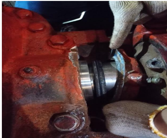
Gambar 4. keretakan pada carbon mechanical seal .Sumber: Penulis (2024)
