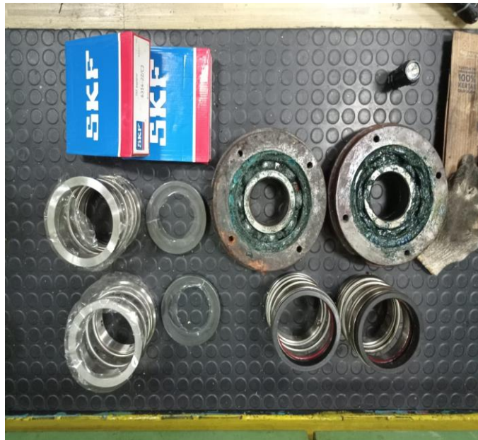
Gambar 7. mechanical seal dan ball bearing baru .Sumber: Penulis (2024)
