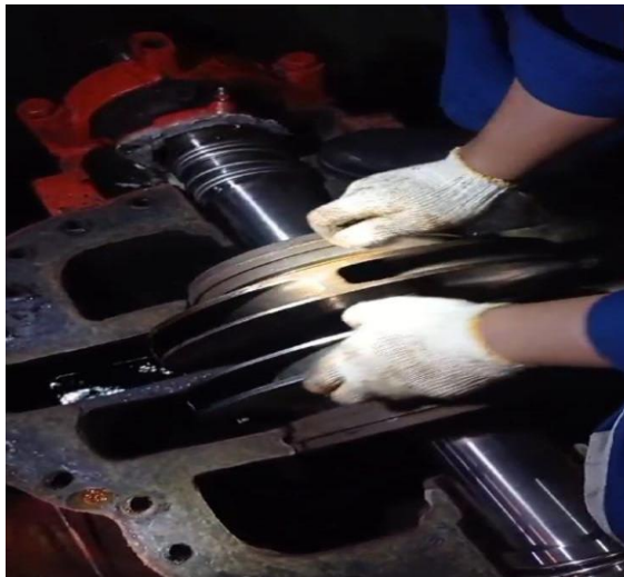
Gambar 5. pengecekan shaft dan impeller .Sumber: Penulis (2024)
