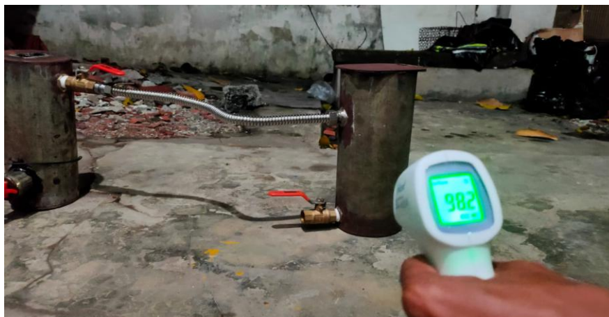
Gambar 3. Pengujian sensor suhu di luar tanki bahan bakar
