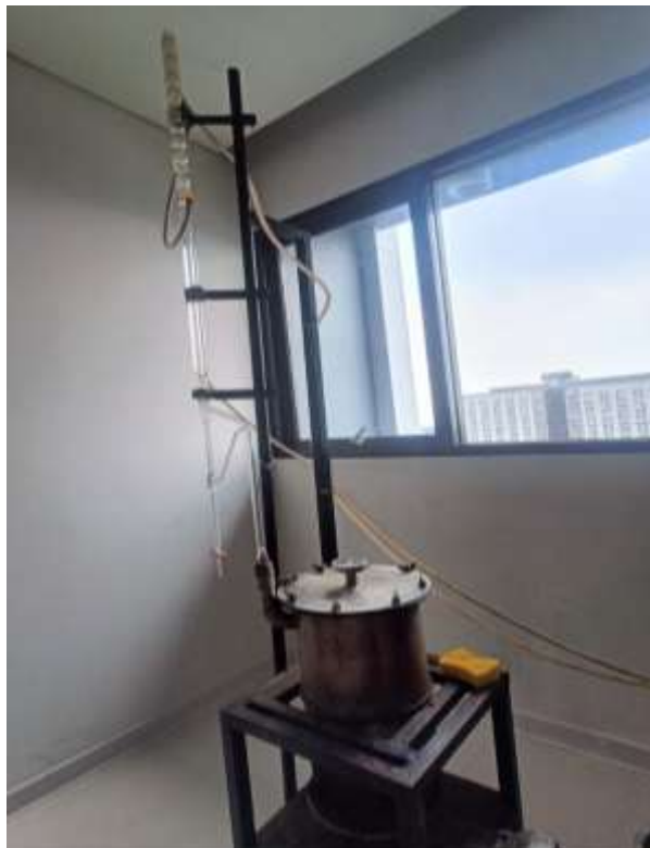
Gambar 2. Set Alat Penyulingan Metode Distilasi Uap Air-Kohobasi
