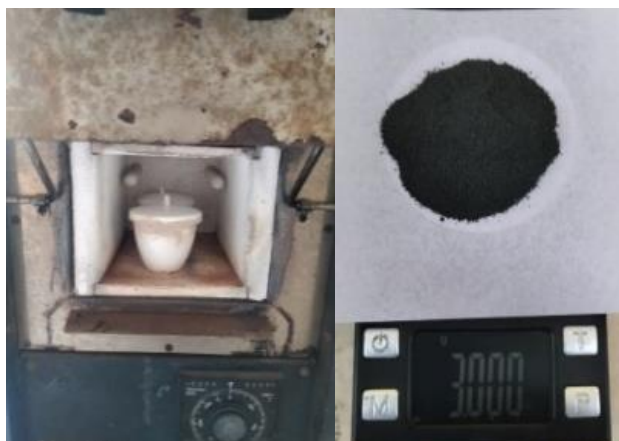
Gambar 2. Tahap Grapitisasi dengan Metode Sintering.
