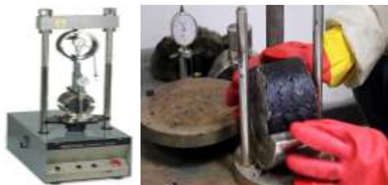
Gambar 1. Alat uji marshall dan ilustrasi.
