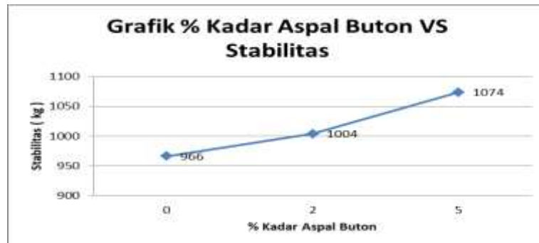
Gambar 1. Grafik Hubungan antara % Kadar Aspal Buton vs Stabilitas.
