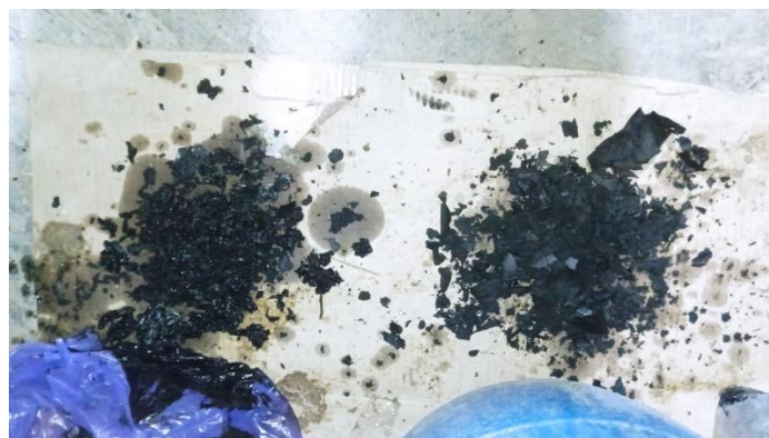
Gambar 5. Hasil Residu Proses Pirolisis Sampah Plastik Kresek.
