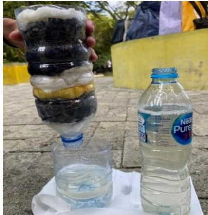
Gambar 2. Rangkaian Filter Air Dan Hasil Filturnya.
