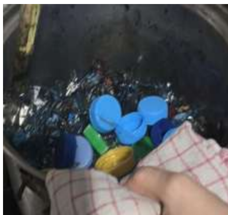
Gambar 1. Proses memasak limbah plastik hingga menghasilkan bubur plastic.
