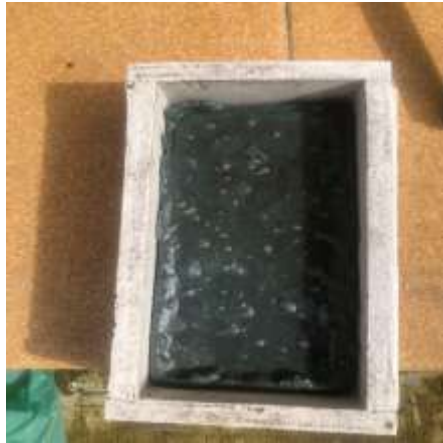
Gambar 3. Proses pencetakan batu bata.
