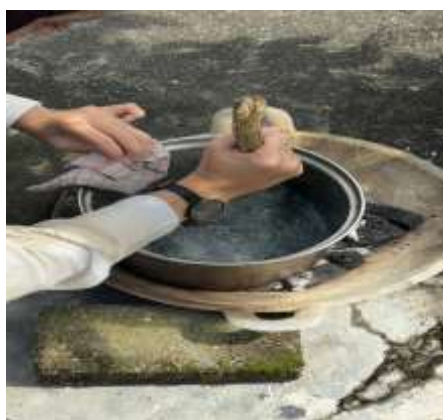
Gambar 2. Proses pengadukan semua bahan yang sudah di campur ke dalam bubur plastic.
